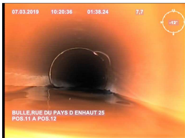
Photo: 6_4A 7.7m, Niveau d'eau, effluent clair
